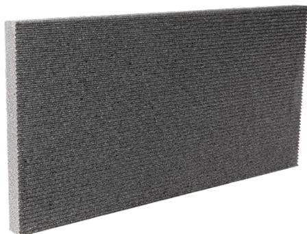
Panel aislante destensado idóneo para la aplicación por capas, realizado en poliestireno expandido sinterizado EPS con aditivo de grafito, con moleteado externo para mejorar la resistencia del sistema a los impactos. Termok8 A.R. Máx 20 J y 60 J.
